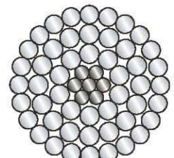
7 sợi thép + 54 sợi nhôm 7 steel wire + 54 Al. wire
