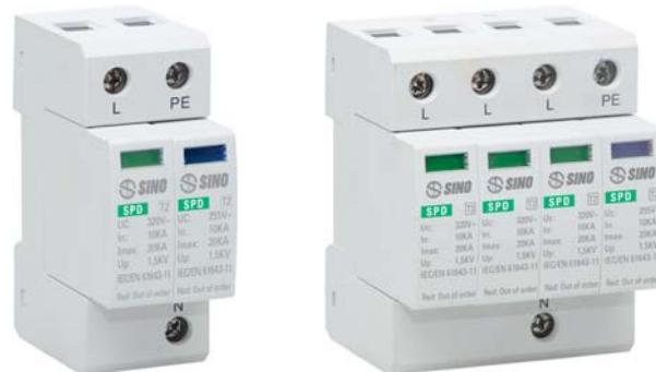
Bộ chống sét lan truyền là một thiết bị được thiết kế để bảo vệ các thiết bị điện trong hệ thống khỏi xung quá áp. Thiết bị này nhằm giới hạn điện áp xông vào hệ thống bằng cách xả bất cứ dòng xung sét có mức điện áp xung cao hơn ngưỡng an toàn cho phép xuống đất. Bộ chống sét lan truyền bảo vệ xung điện không chỉ gây ra bởi sét đánh.
